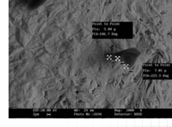
TSSOP (Pb-free reflow) MAX Whisker : 12.05um
